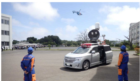
応急通信対策車による警察用航空機からの映像受信及び衛星設備での映像伝送訓練
